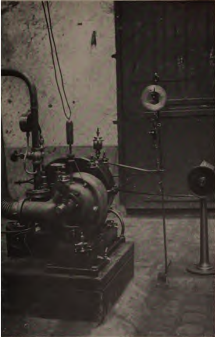
9.—The 30 horse-power experimental gas turbine of the Société des Turbomoteurs.
